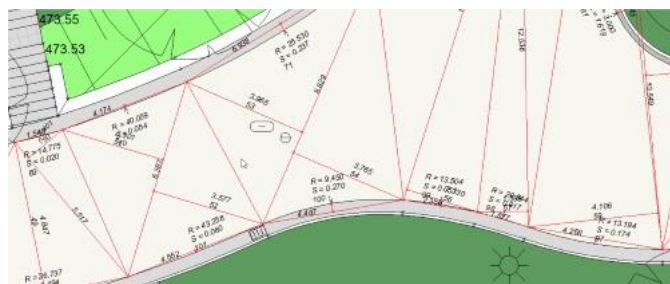
Flächenzerlegung in iTWO civil
